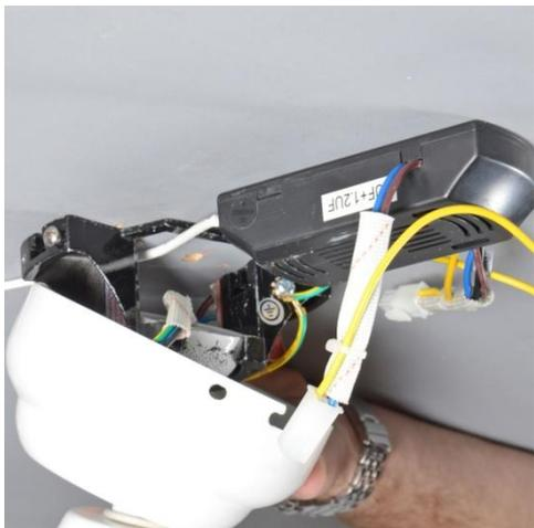
Montieren Sie den Empfänger wie in der Abbildung dargestellt.
